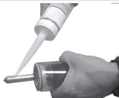
Adăugați rășina termoconductoare pe condensatorul țevii heat-pipe.
