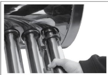
Lubrificați inelele antipraf și tubul cu apă cu săpun Introduceți și rotiți tuburile în rezervor
